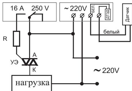
Рис.5 Схема подключения нагрузки через симистор.
