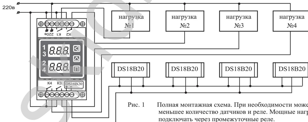
Рис. 1 Полная монтажная схема. При необходимости может быть использовано меньшее количество датчиков и реле. Мощные нагрузки желательно подключать через промежуточные реле.
