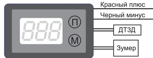
Во время прерывистого звукового сигнала цифры на индикаторе гаснут в пртивофазе звуку. Если прибор настроен на постоянный звуковой сигнал, то цифры на индикаторе не гаснут. Во всех случаях после последнего нажатия любой из кнопок система через 5 секунд выходит в основной режим (индикация температуры и обработка заданных параметров) с сохранением изменений .
