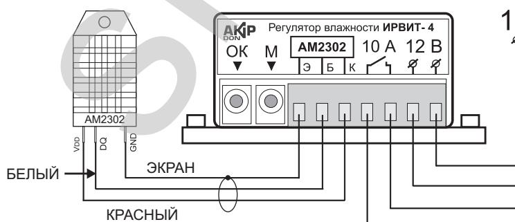
**12 В** Полярность питающего напряжения может быть произвольной.
