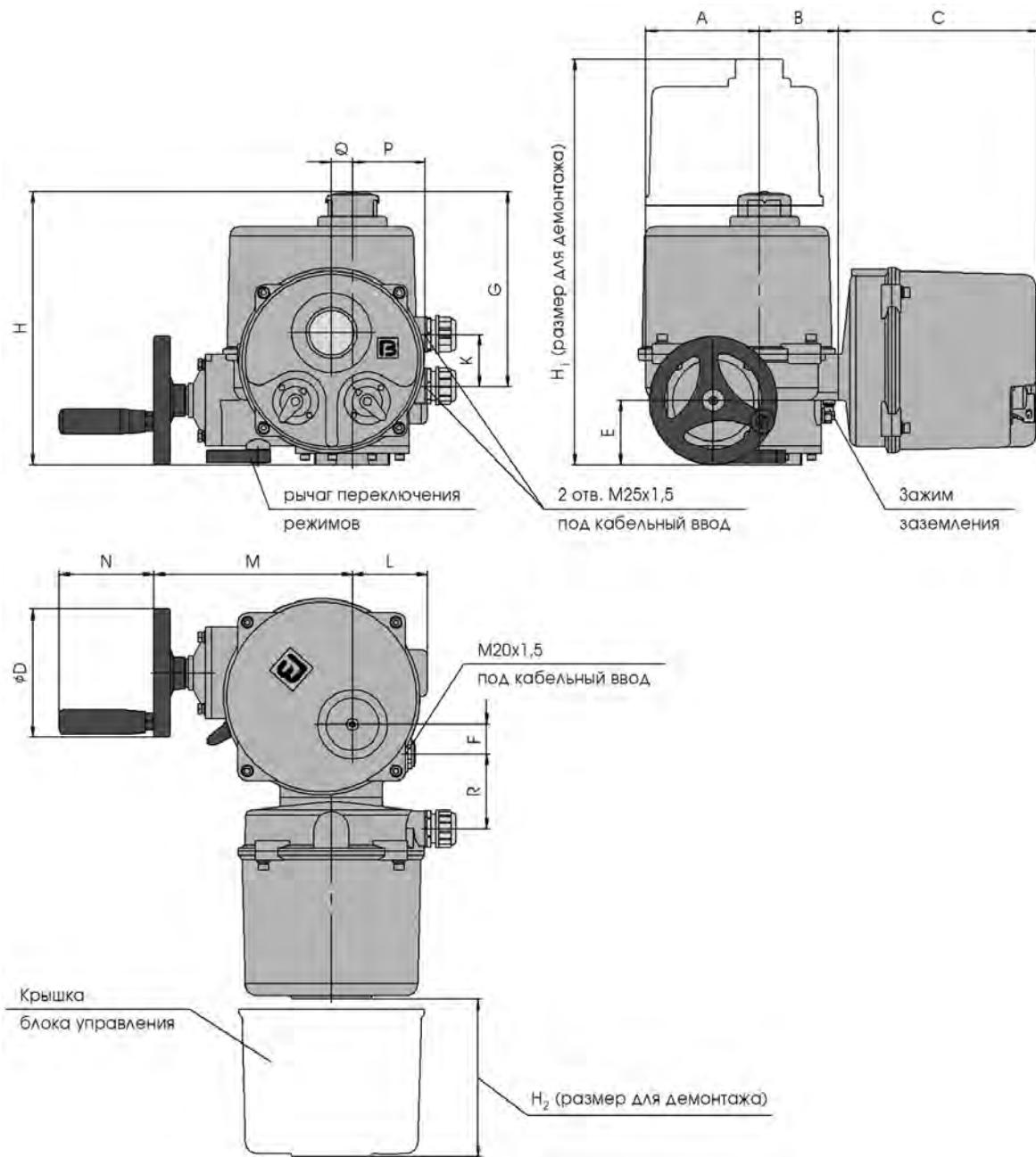
**Размеры электроприводов ГЗ-ОФ (М) КС типоразмеры 8101, 8102, 8103**
