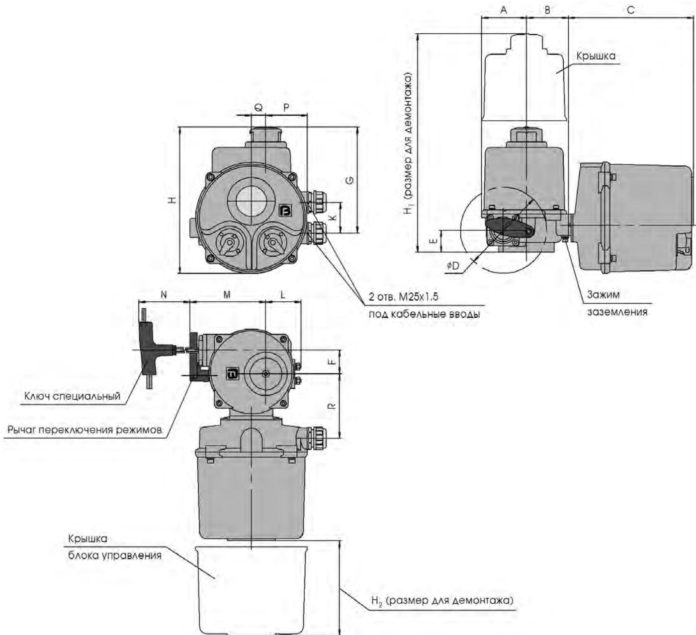
Размеры электроприводов Г3-ОФ (К) КС типоразмер 8100
