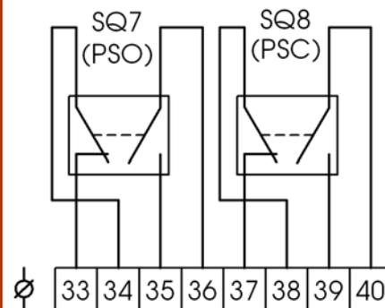
Схема электрическая соединений 903PS с путевыми выключателями
