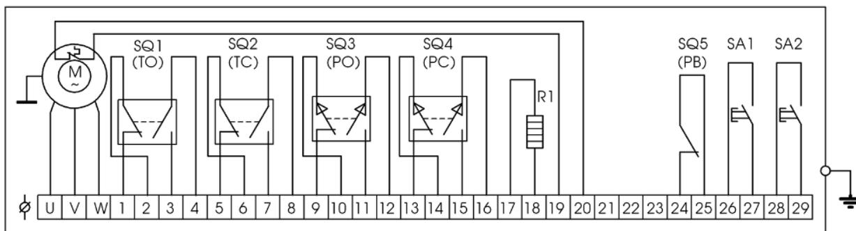
Схема электрическая соединений CE211-35C электропривода многооборотного общепромышленного исполнения ГЗ-А типоразмер 9031, ГЗ-Б типоразмер 9032 питанием ЗАС 400В 50Гц
