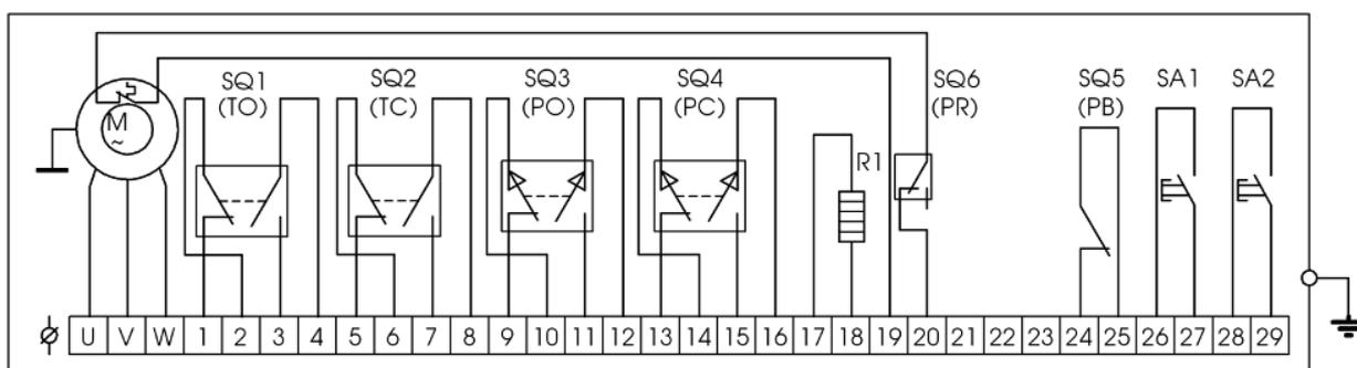
Схема электрическая соединений CE211-42A электропривода многооборотного общепромышленного исполнения ГЗ-В типоразмер 9034, ГЗ-Г типоразмер 9035, ГЗ-Д типоразмер 9036 питанием ЗАС 400В 50Гц
