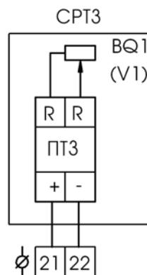
Схема электрическая соединений 903CPT3 с токовым выходом
