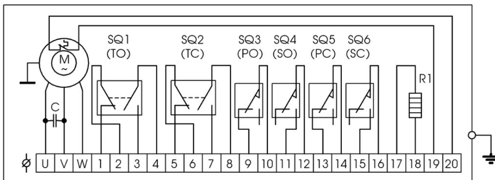
Схема электрическая соединений CE313D электропривода многооборотного общепромышленного исполнения ГЗ-А типоразмер 9030 питанием AC 230В 50Гц
