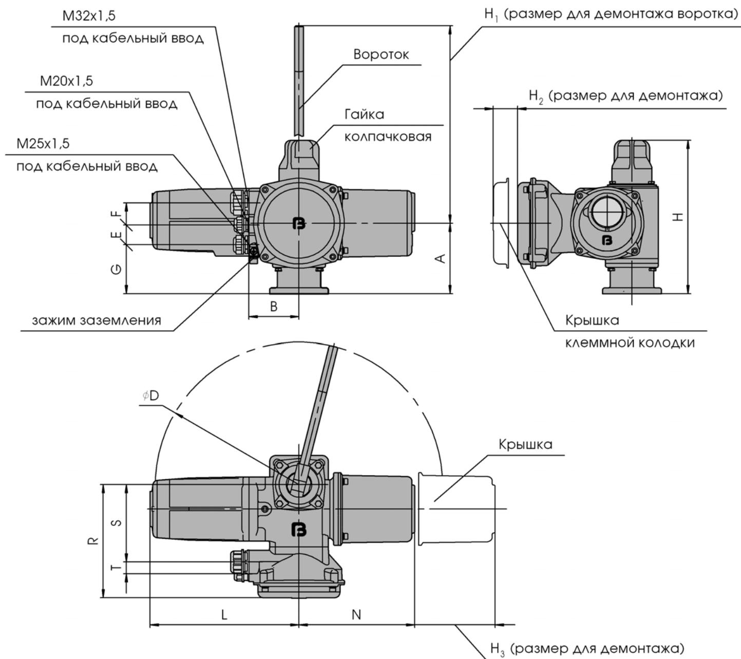
Размеры электроприводов ГЗ-А.50(70) типоразмер 9030
