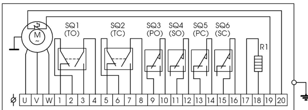
Схема электрическая соединений CE311-2B электропривода многооборотного общепромышленного исполнения ГЗ-А типоразмер 9030 питанием 3AC 400В 50Гц
