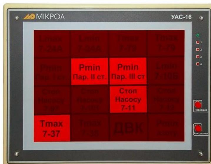
**Устройство аварийной сигнализации**
