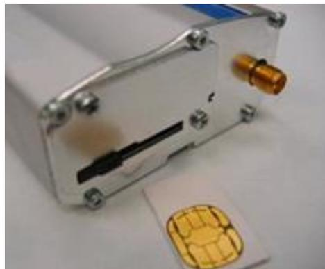
Рисунок 6.11 - Выдвинуть крышку держателя
