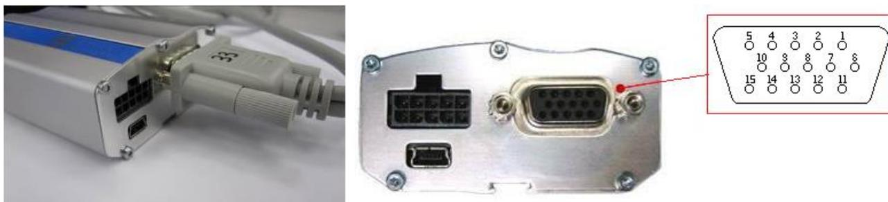
Рисунок 6.2 - Схема разъёма последовательного интерфейса RS-232
