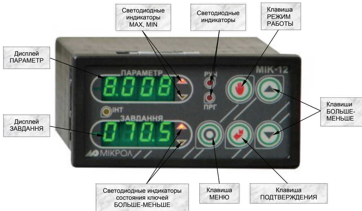
Рисунок 5.1 - Внешний вид передней панели регулятора МИК-12
