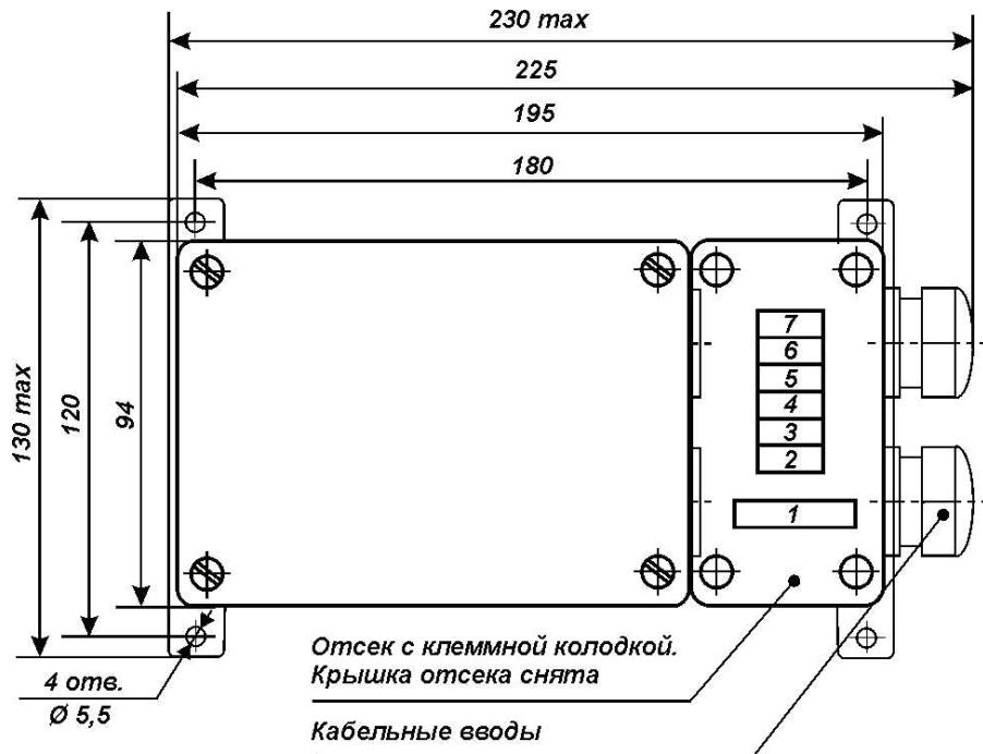
Рисунок А.3 - Габаритные размеры ПП-10-1
