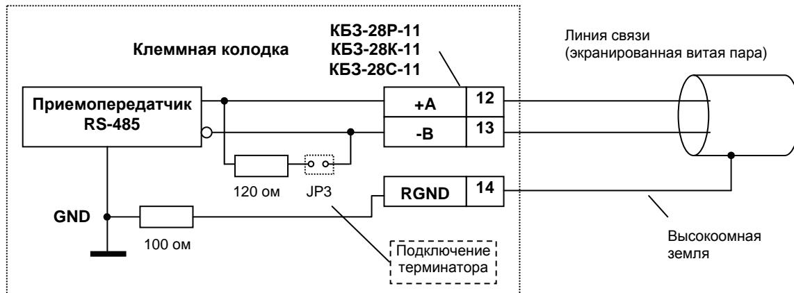
Рисунок Б.22 - Рекомендуемая схема подключения интерфейса RS-485 с помощью КБ3-28Р-11, КБ3-28К-11 или КБ3-28С-11
