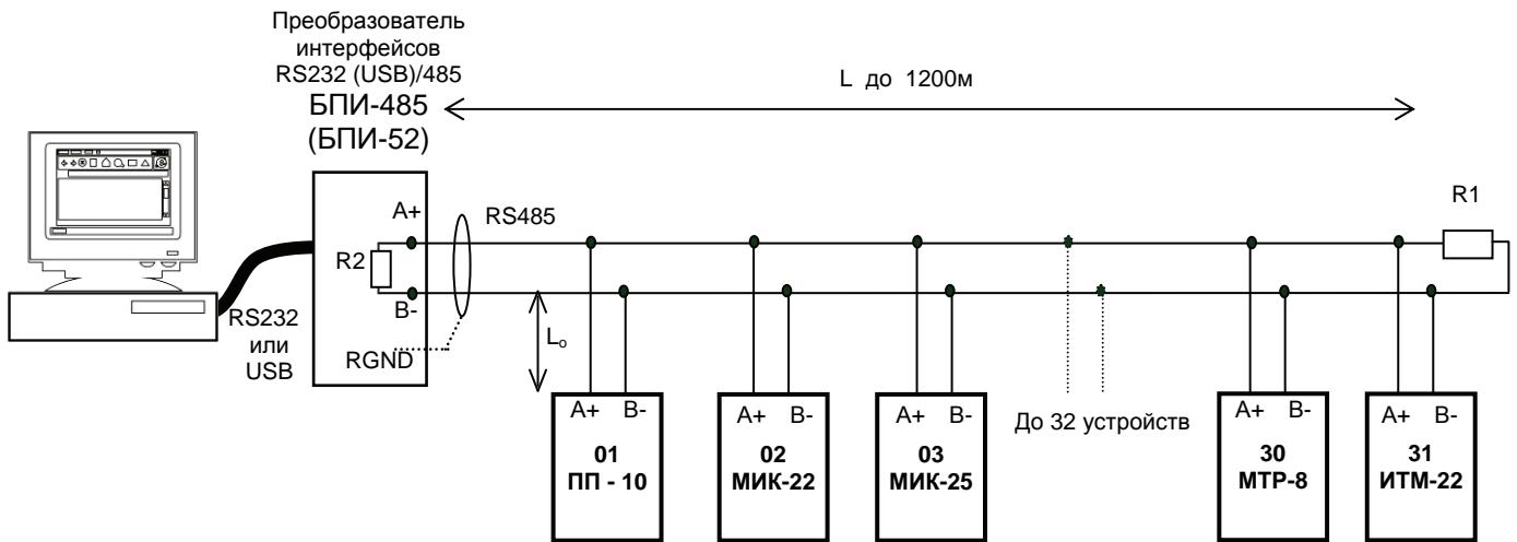
Рисунок Б.20 - Организация интерфейсной связи между компьютером и регуляторами
