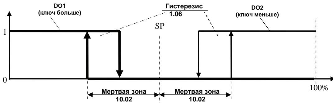
Рисунок В.1 - График работы дискретных выходов 3-х позиционного регулятора с использованием зоны нечувствительности (10.02)
