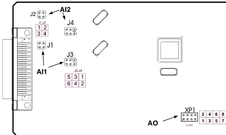
Рисунок 10.2.1 – Положение перемычек на плате процессора
