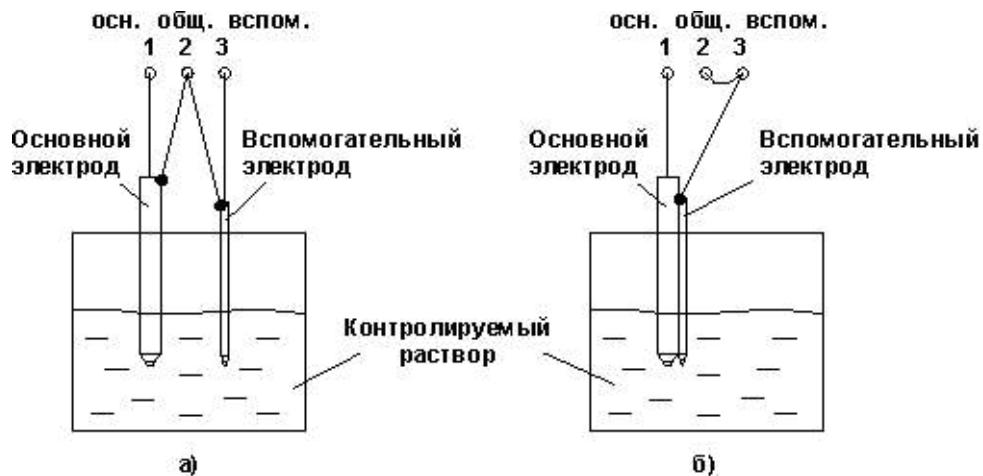
Рисунок Б.10 - Подключение электродной системы к измерительному преобразователю ПП-10-1
