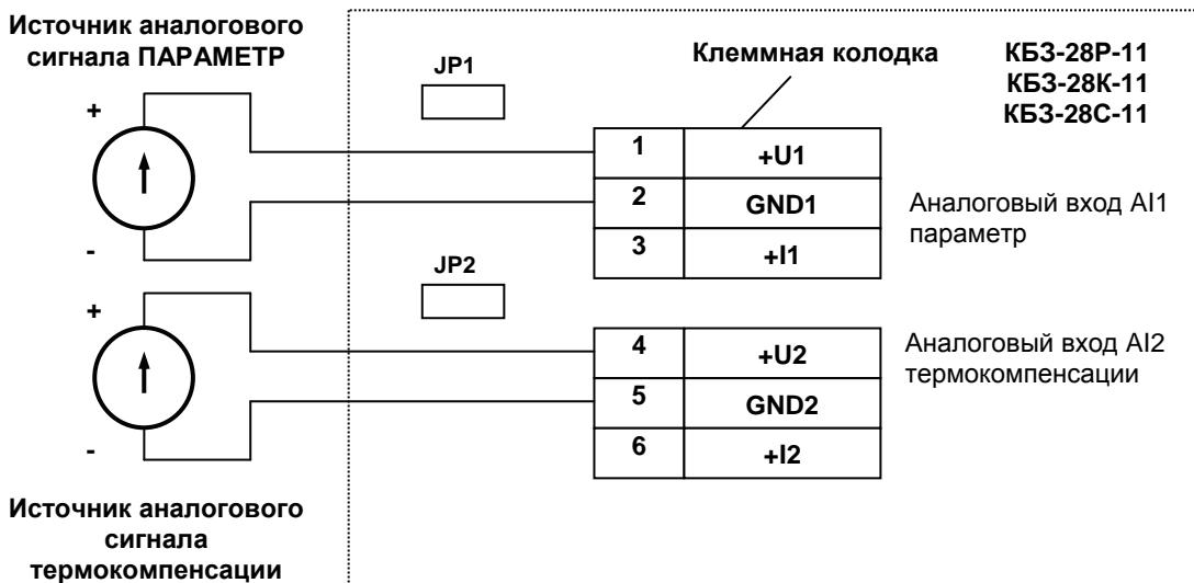
Где JP1 и JP2 – перемычки, установленные на клеммной колодке КБ3-28Р-11, КБ3-28К-11, КБ3-28С-11.
