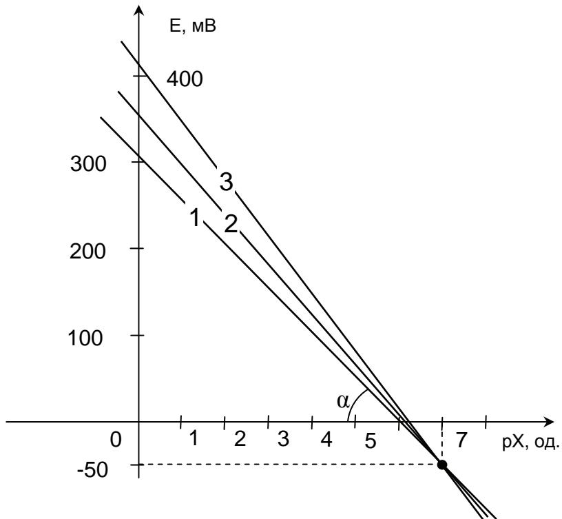
Рисунок 5.3. Электродные характеристики для различных значений  $T_p$ .
