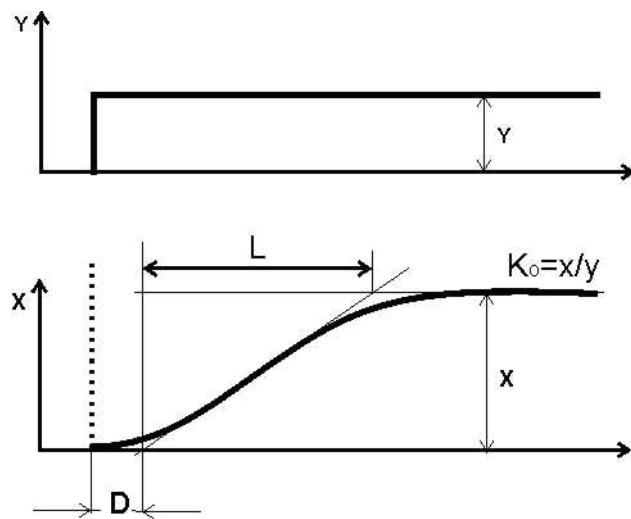
Рисунок 10.1 - Переходная функция объекта регулирования с самовыравниванием
