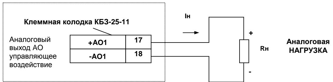
I<sub>H</sub> – выходной ток аналогового выхода, R<sub>H</sub> - нагрузка
