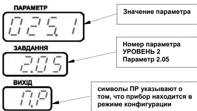
Рисунок 6.3. Индикация значения параметров конфигурации и их номеров.
