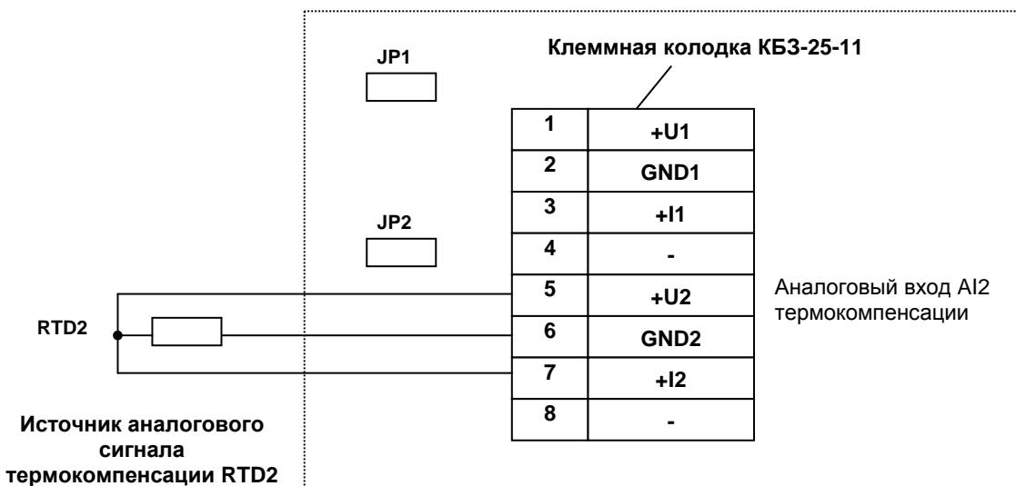
Где JP1 и JP2 – перемычки, установленные на клеммной колодке КБЗ-25-11.
