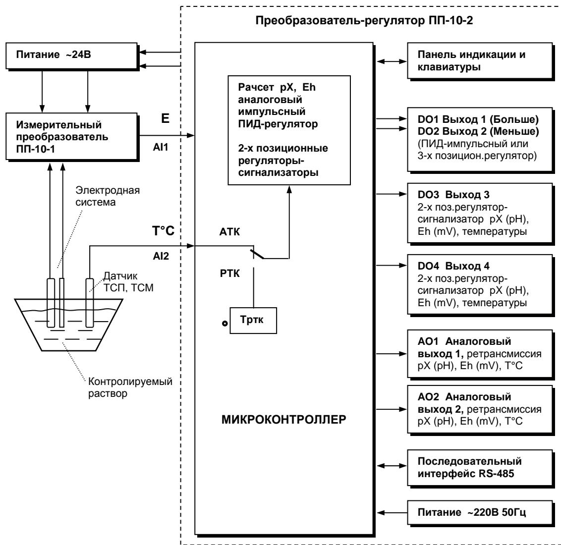
Рисунок 5.2. Структурная схема микропроцессорного преобразователя-регулятора потенциометрического ПП-10-2, в комплекте с измерительным преобразователем ПП-10-1
