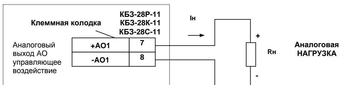
Рисунок Б.12 - Подключение аналоговых нагрузок с помощью КБ3-28Р-11, КБ3-28К-11, КБ3-28С-11
