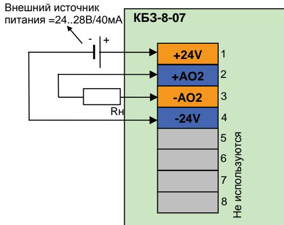
Рисунок Б.14 - Подключение сигналов модуля расширения МР-51-05 с помощью клеммно-блочного соединителя КБЗ-8-07
