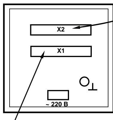
Разъём расширения (подключение дополнительного аналогового выхода с помощью модуля расширения МР-51-05)
