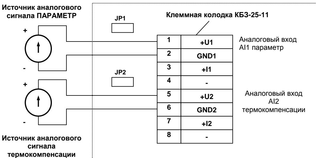
Где JP1 и JP2 – перемычки, установленные на клеммной колодке КБЗ-25-11.
