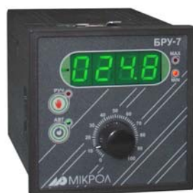
Рисунок А.1 – Внешний вид блока ручного управления БРУ-7
