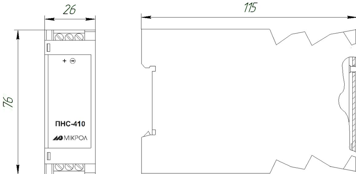
Рисунок 1.1 - Внешний вид и габаритные размеры ПНС-410
