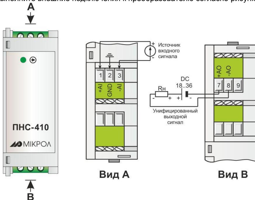
Рисунок 4.3 - Схема электрических подключений
