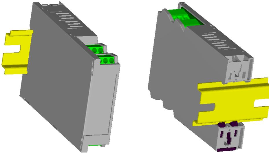
Рисунок 4.1 - Схема крепления преобразователя на щит
