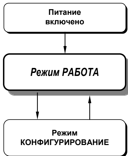
Рисунок 4.6.1 – Диаграмма режимов работы и настройки преобразователя ПНС-13
