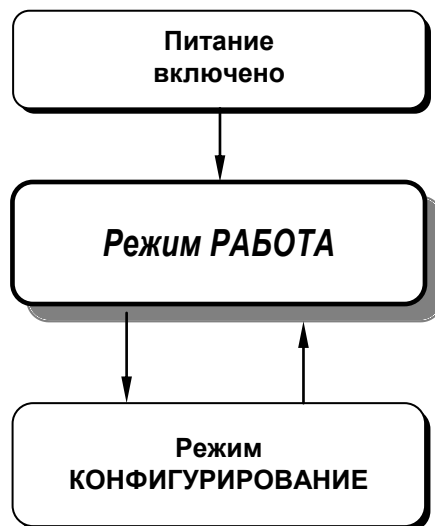
Рисунок 4.6.1 – Диаграмма режимов работы и настройки преобразователя ПНС-11
