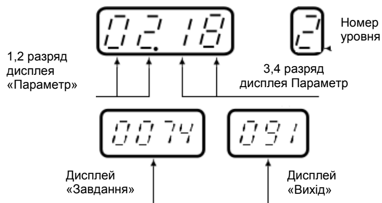
Рисунок 7.2 Индикация параметров настройки в режиме программирования
