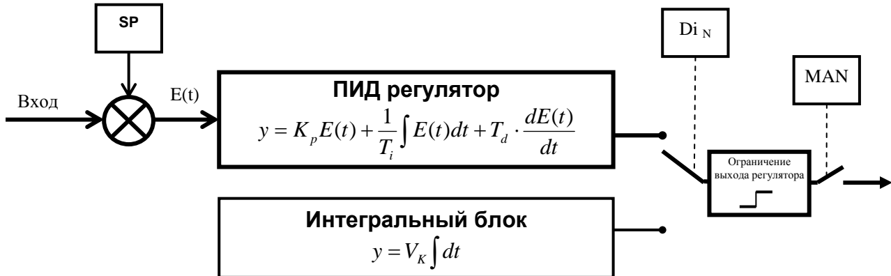
Рисунок 5.4 - Структурная схема регулятора с коррекцией по дискретному входу.
