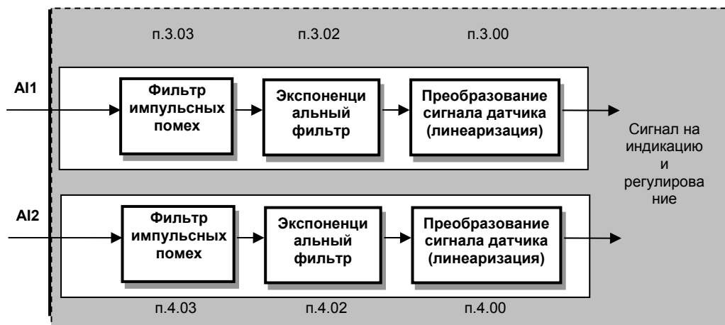
Рисунок В.4 – Функциональная схема программного преобразования входных аналоговых сигналов
