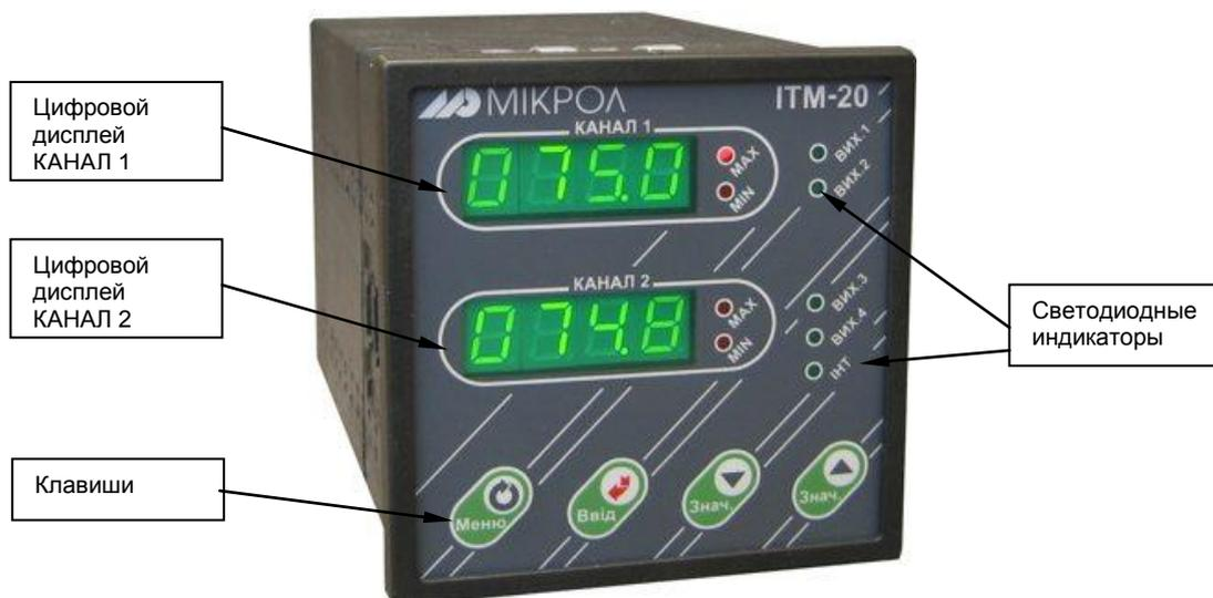
Рисунок 3.2 - Внешний вид передней панели индикатора ИТМ-20У
