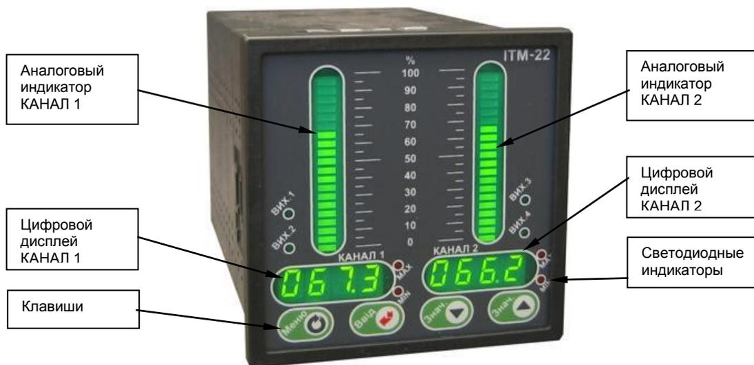
Рисунок 3.1 - Внешний вид передней панели индикатора ИТМ-22У
