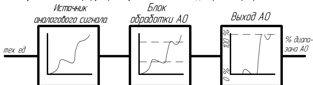
Рисунок 3.6 – Работа блока аналогового вывода в режиме ретрансмиссии
