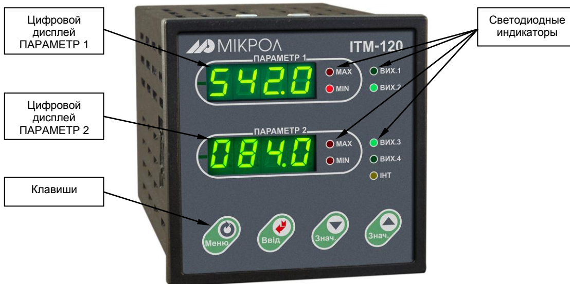
Рисунок 3.1 - Внешний вид передней панели индикатора ИТМ-120У
