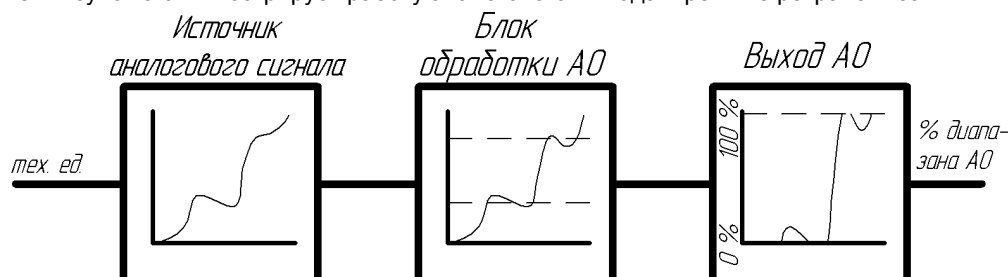
Рисунок 3.6 – Работа блока аналогового вывода в режиме ретрансмиссии
