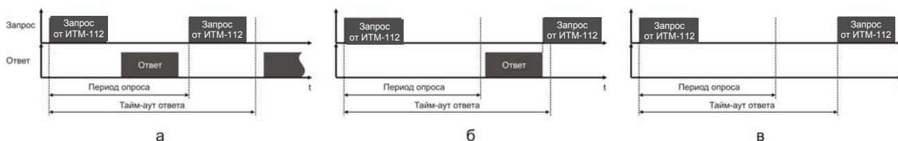
Рисунок В.2 - Временные диаграммы приема-передачи данных ИТМ-112 в режиме MASTER
