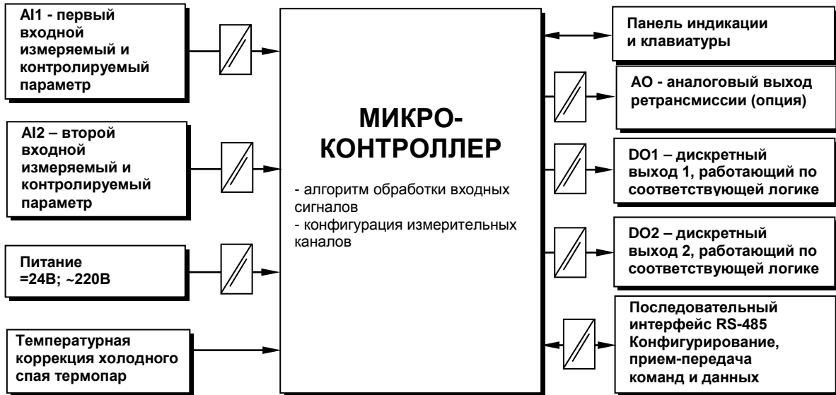
Рисунок 3.2 - Структурная схема индикатора ИТМ-112
