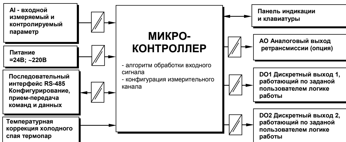
Рисунок 3.2 - Структурная схема индикатора ИТМ-111Н
