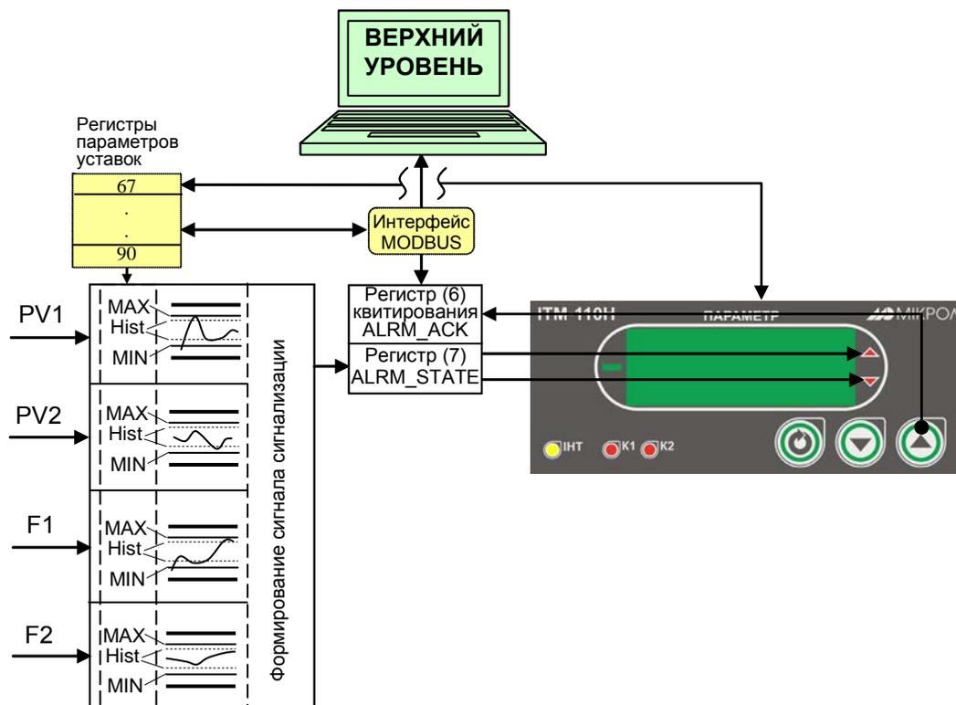
Рисунок 3.5 – Блок-схема блока сигнализации
