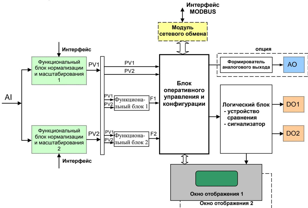
Рисунок 3.3 - Функциональная схема индикатора ИТМ-110Н
