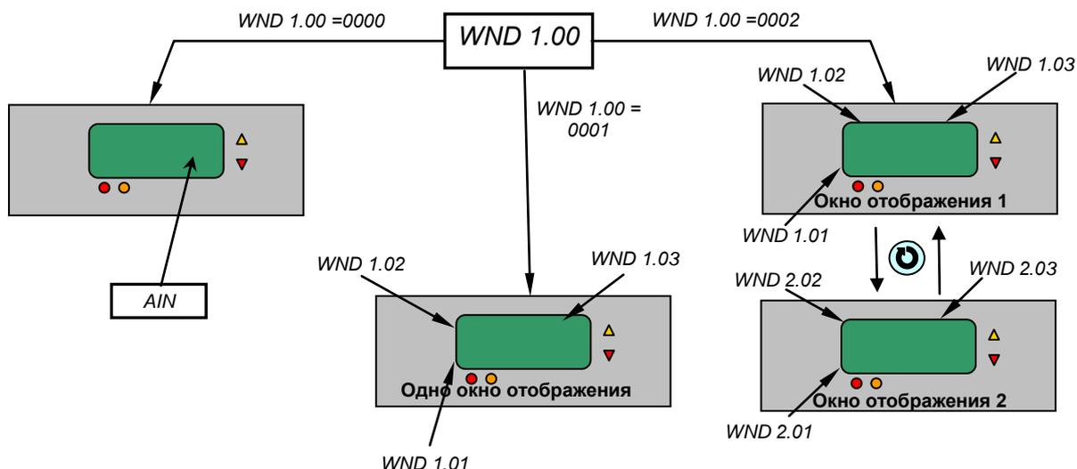
Рисунок 3.6 – Блок-схема выбора вариантов отображения измерительного параметра
