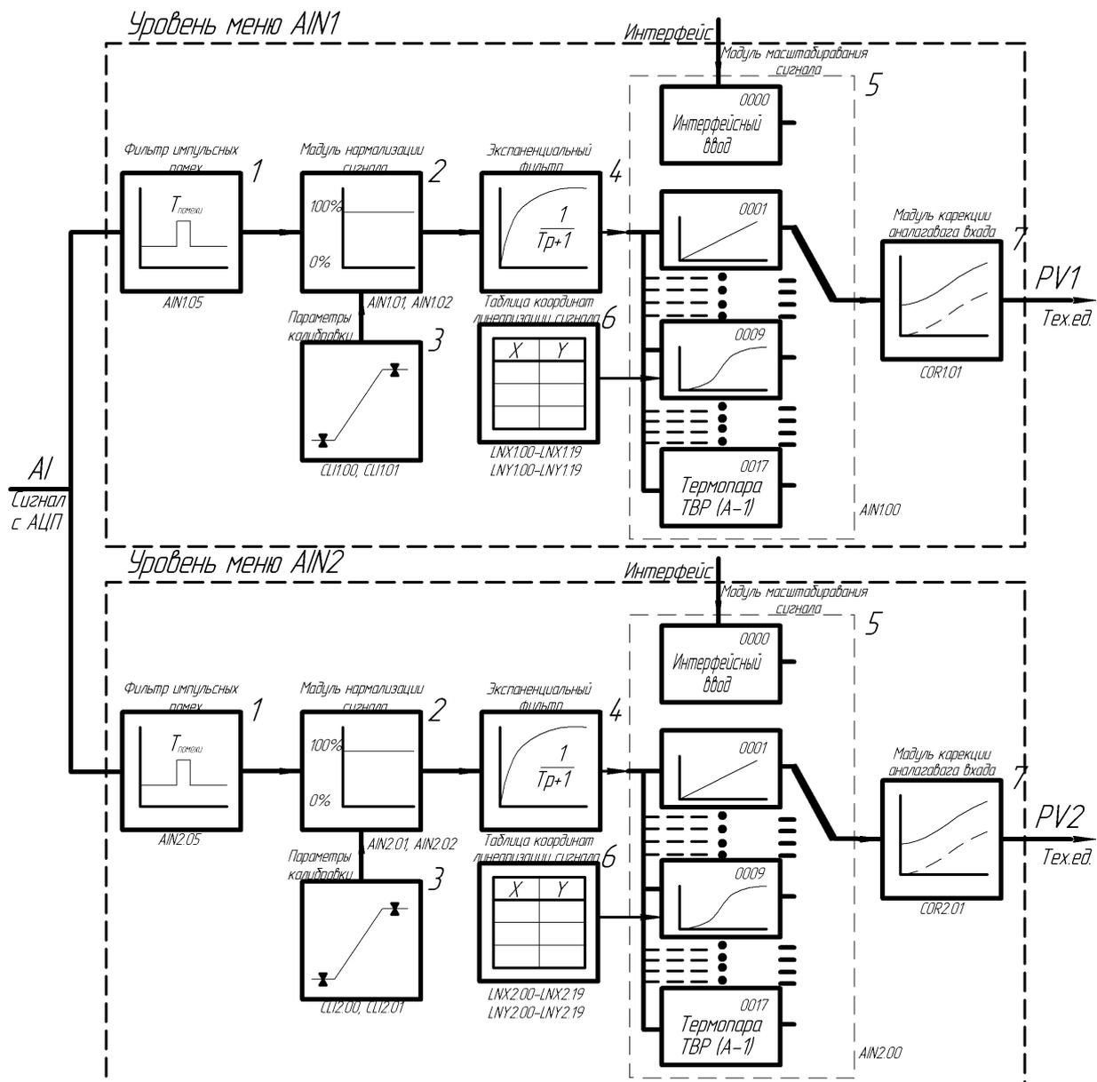
Рисунок 3.4 – Блок-схема функциональных блоков нормализации и масштабирования
