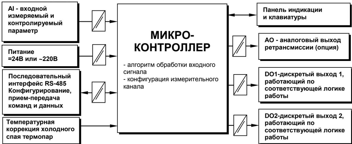
Рисунок 3.2 - Структурная схема индикатора ИТМ-110Н
