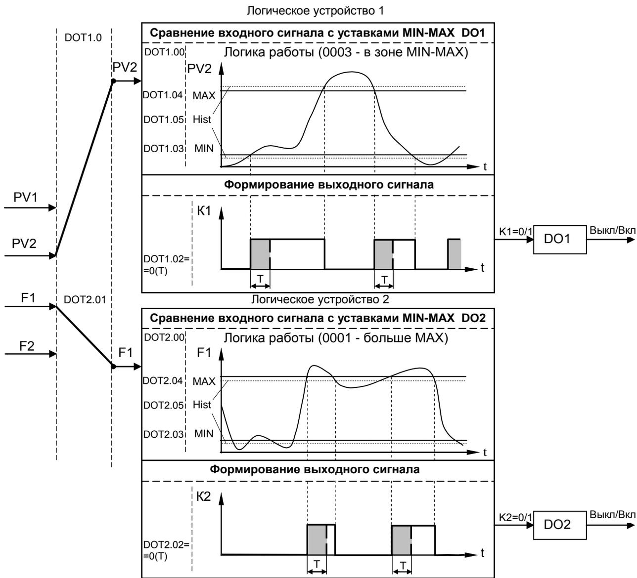
Рисунок 3.7 – Диаграмма работы логических устройств
