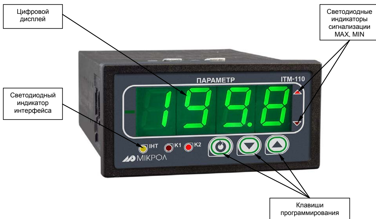
Рисунок 2.1 - Внешний вид передней панели индикатора ИТМ-110С
