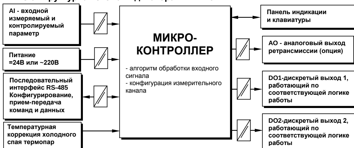
Рисунок 3.2 - Структурная схема индикатора ИТМ-110
