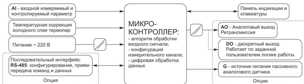
Рисунок 3.2 - Структурная схема индикатора ИТМ-101(В)
