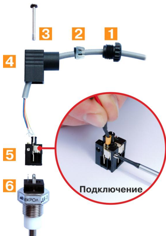
Рисунок 2 – Подключение проводов к полюсам коннектора держателя ДК-1
