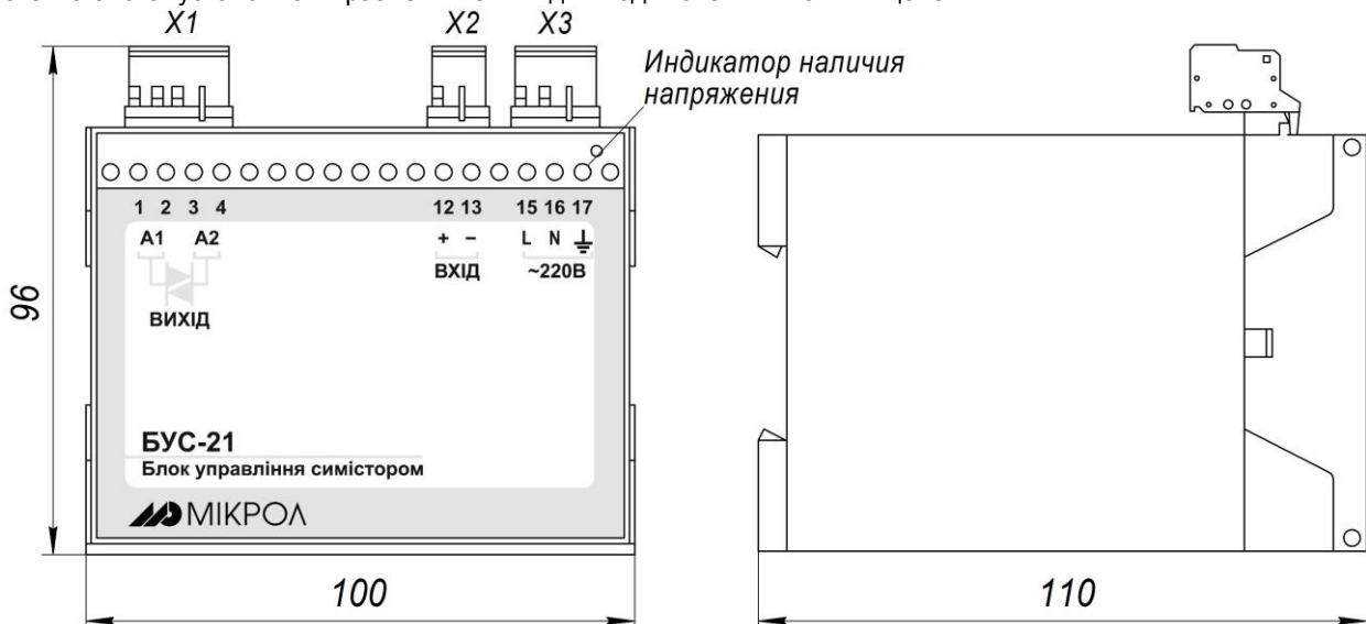
Рисунок 1.4 – Внешний вид и габаритные размеры блока БУС-21
