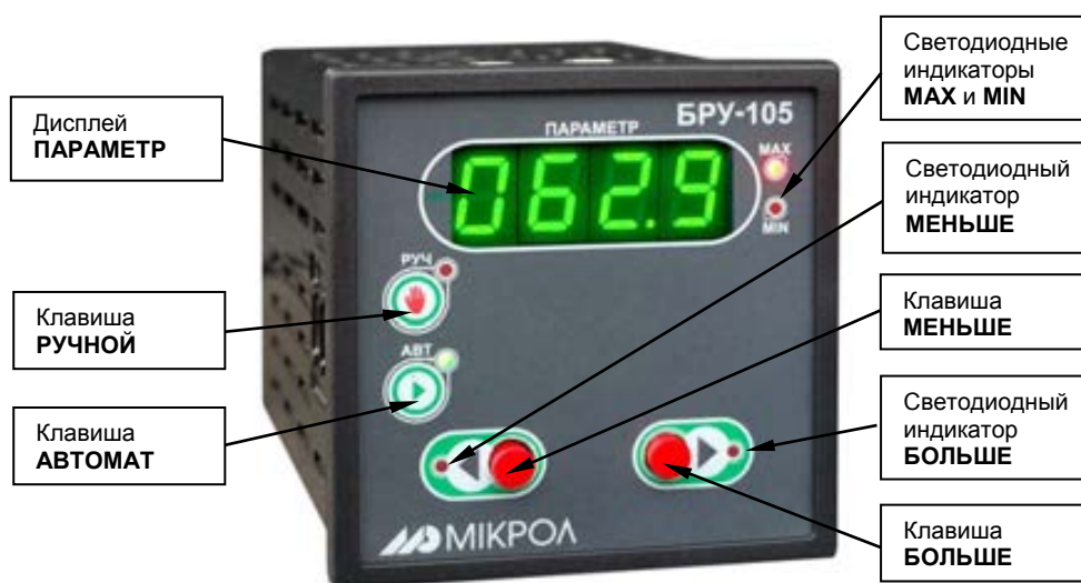
Рисунок 3.1 - Внешний вид передней панели блока ручного управления БРУ-105
