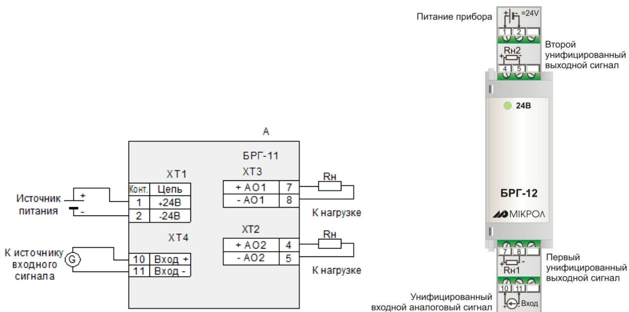
Рисунок 3.3 - Схема электрических подключений преобразователя БРГ-12
