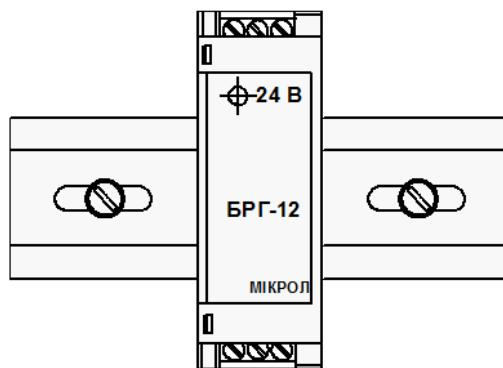
Рисунок 3.1 - Монтаж преобразователя - разветвителя аналоговых сигналов БРГ-12
