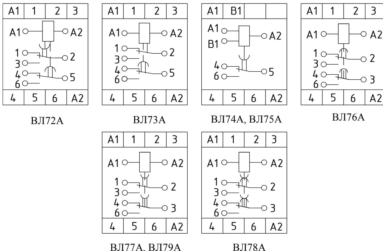
**Рисунок 2 - Схемы подключения реле**
