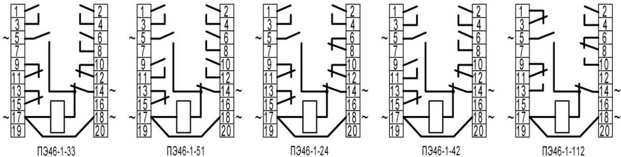
(~) - зажимы для подключения обмоток включающей и отключающей ;
