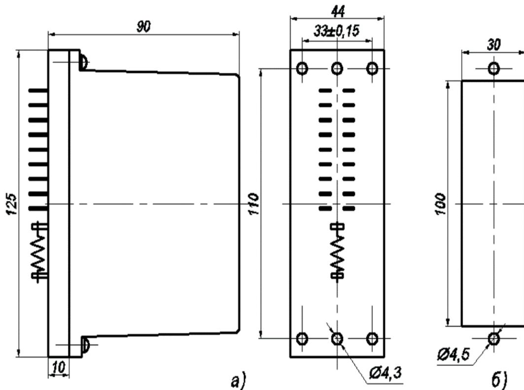
а) общий вид реле; б) разметка панели
