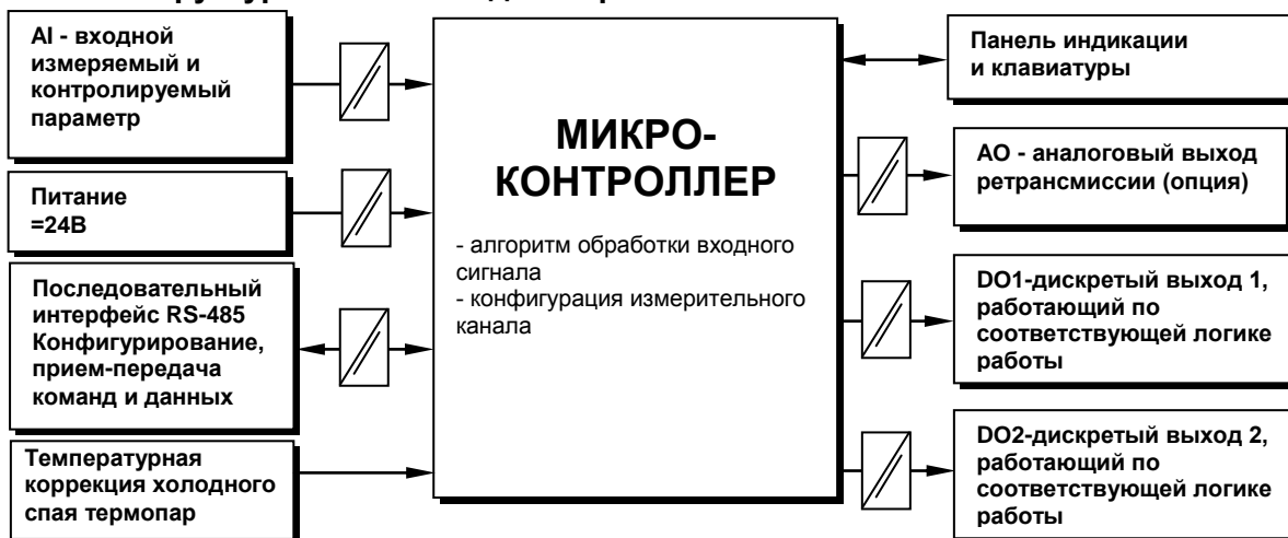
Рисунок 5.2 - Структурная схема индикатора ИТМ-10
