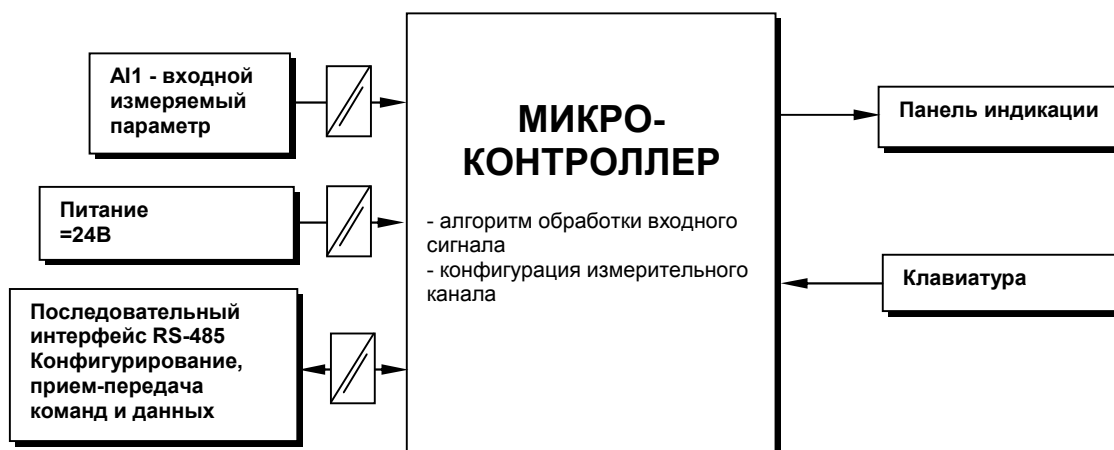
Рисунок 5.3 - Структурная схема индикаторов ИТМ-1-01-31 и ИТМ-1-01-41
