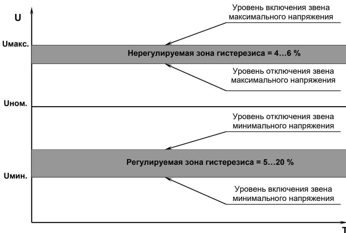
**Рисунок 8** - Уровни включения/отключения звеньев максимального и минимального напряжений.
