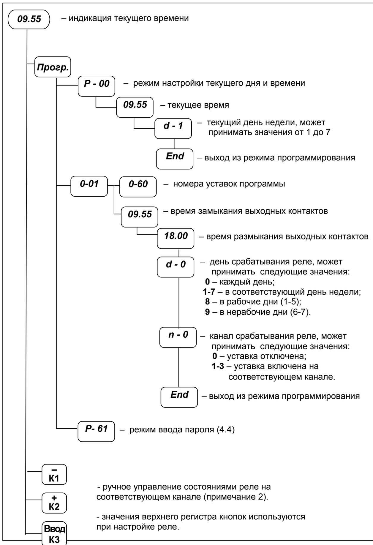
Рисунок 5 - Порядок настройки уставок реле РВЦ-03-11, РВЦ-03-13
