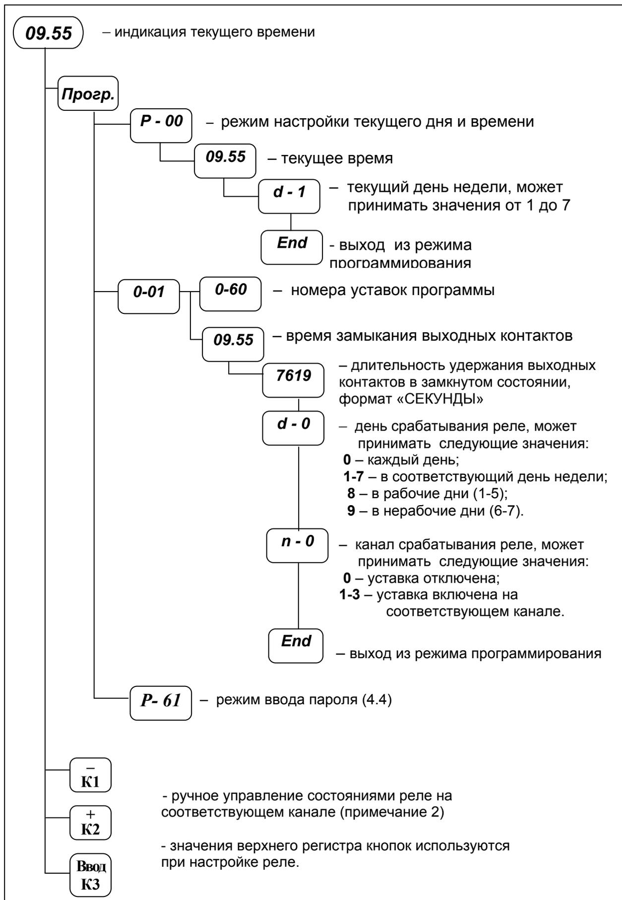
Рисунок 6 - Порядок настройки уставок реле РВЦ-03-12, РВЦ-03-14
