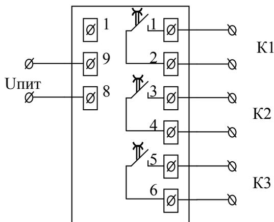
K1, K2, K3 – клеммы каналов управления нагрузкой;
