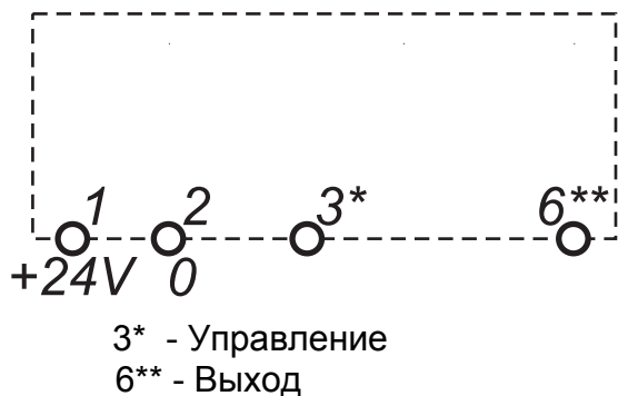
Рисунок 3 - Схема подключения реле ВЛ-63
