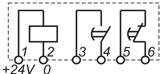
**Рисунок 7** - Схема подключения реле ВЛ-67 на напряжение 24 В
