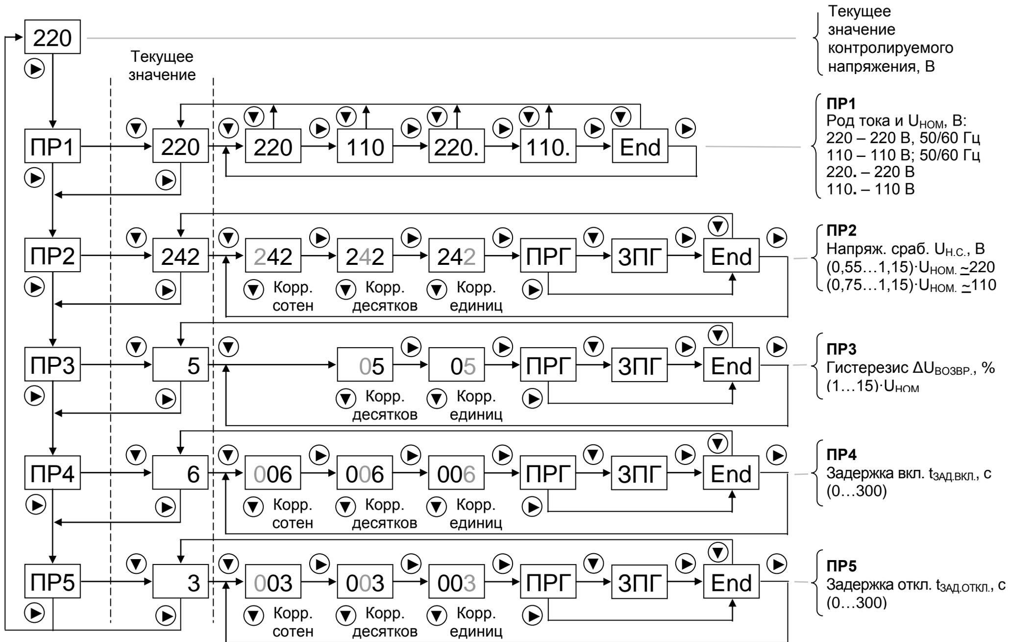
Рисунок 7 - Порядок программирования реле НЛ-18-2
