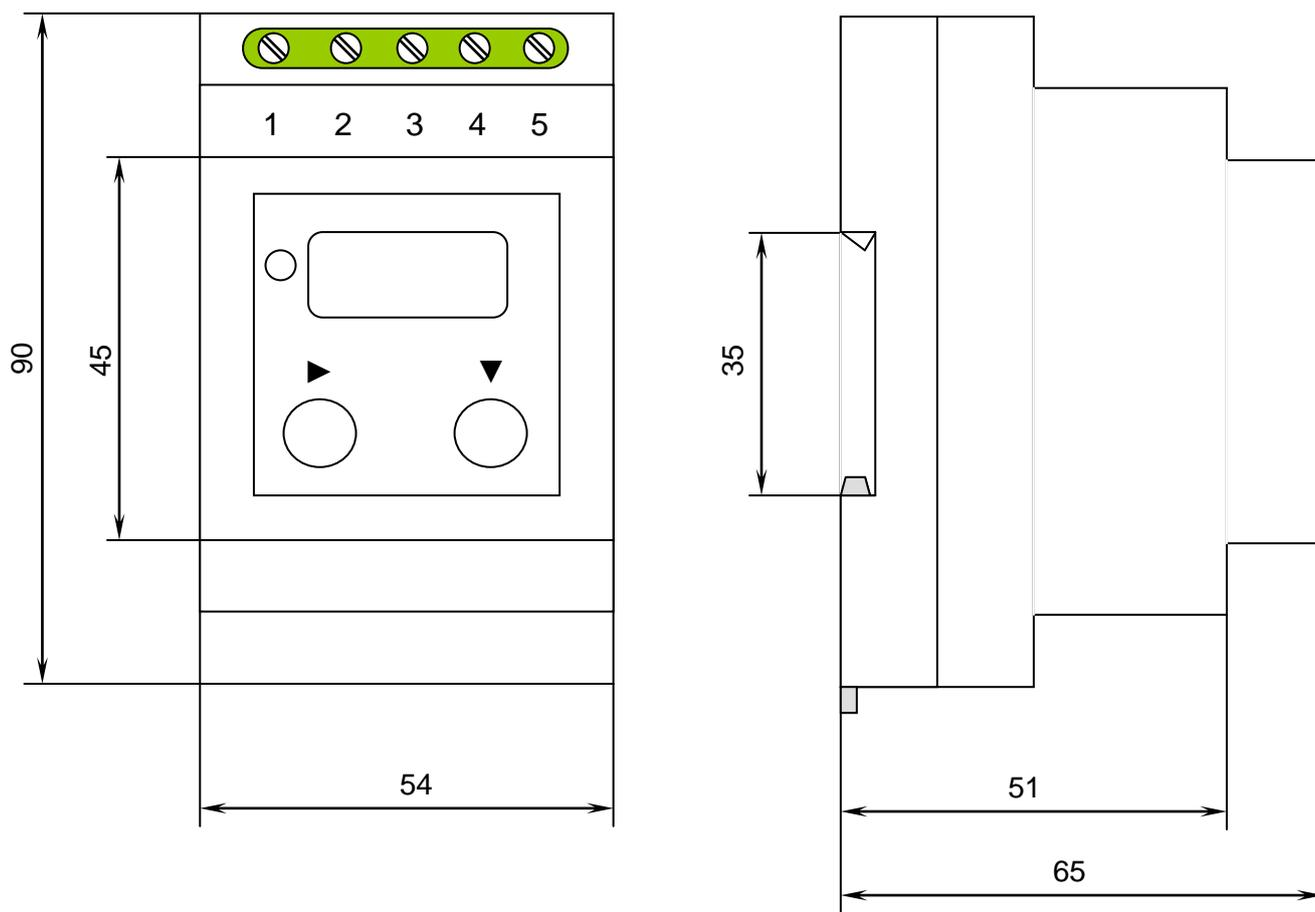
**Рисунок 1** - Габаритные и установочные размеры реле
