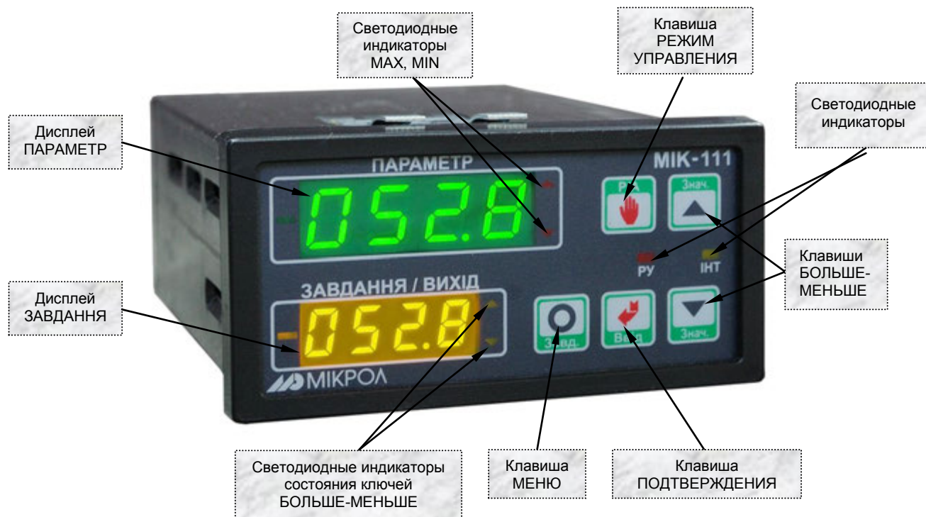
Рисунок 3.1 - Внешний вид передней панели регулятора МИК-111
