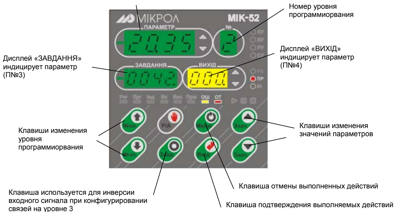
Рисунок 7.1 - Лицевая панель контроллера МИК-52 в режиме программирования
