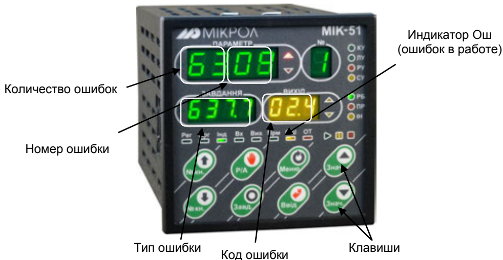
Рисунок 6.12 - Лицевая панель в режиме индикации ошибок
