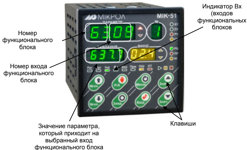
Рисунок 6.9 - Лицевая панель в режиме индикации входных параметров функциональных блоков
