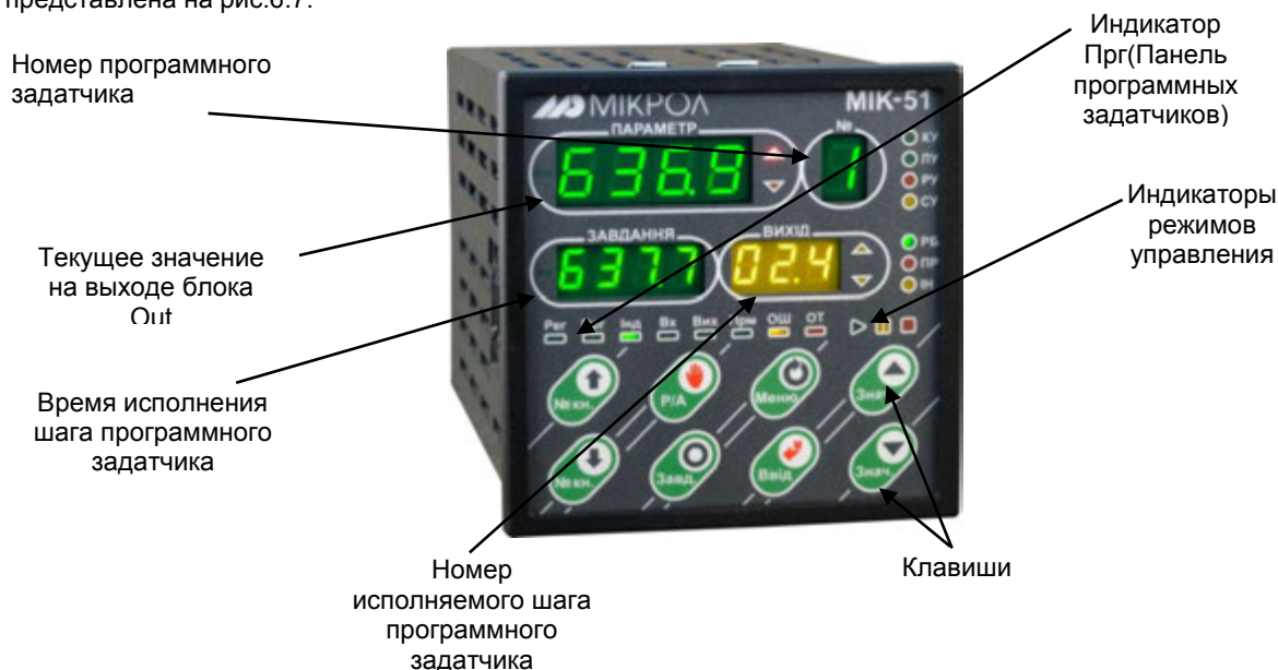
Рисунок 6.7 - Лицевая панель в режиме оперативного управления программным задатчиком
