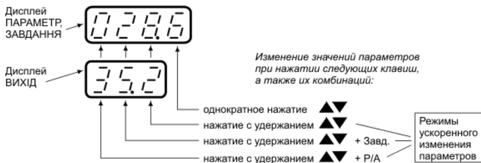
Рисунок 6.3 - Изменение значений на различных дисплеях
