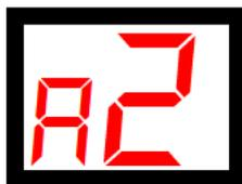
Эта функция служит для установки гистерезиса работы насоса. Это разница между температурой входа в цикл **работы** и температурой возврата в цикл **поддержки** (например: когда *заданная температура* равняется 60°C, а гистерезис составляет 3°C, переход в цикл **работы** произойдет после достижения температуры 60°C, а возврат к циклу **поддержки** произойдет после понижения температуры до 57°C).
