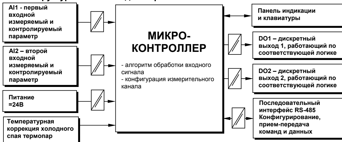
Рисунок 5.2 - Структурная схема индикатора ИТМ-12
