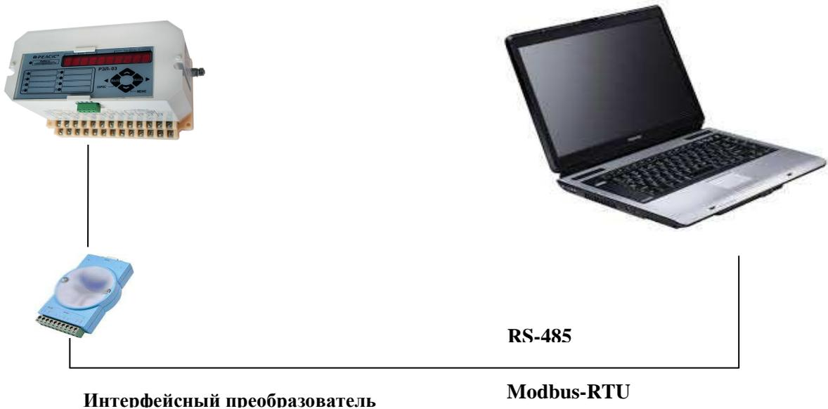
Схема соединения устройства с компьютером
