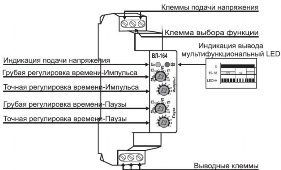
Рисунок 2 - Внешний вид реле, органы управления и примеры сигнализации
