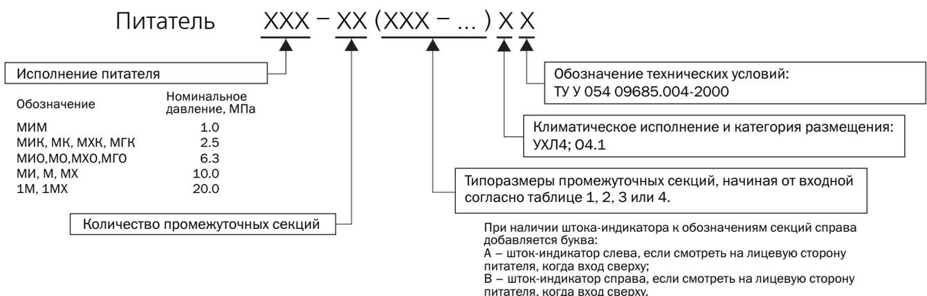
Пример условного обозначения питателя исполнения МИ с тремя промежуточными секциями: первая секция 10ДВ (с номинальным подаваемым объёмом 0,16 см<sup>3</sup>, с двумя отводами и штоком-индикатором, расположенным справа); вторая – 10Е (с номинальным подаваемым объёмом 0,32 см<sup>3</sup> с одним отводом); третья – 5Д (с номинальным подаваемым объёмом 0,08 см<sup>3</sup> с двумя отводами), предназначенного для работы в районах (странах) с умеренным климатом, категория размещения 4:
