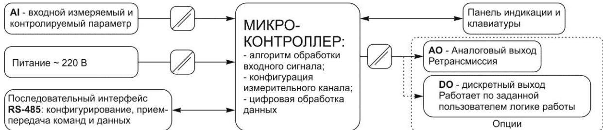
Рисунок 3.2 - Структурная схема амперметра ИПМ-3
