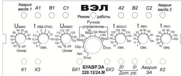
Рис. 2 Расположение органов управления и индикации БУАВР.ЭА
