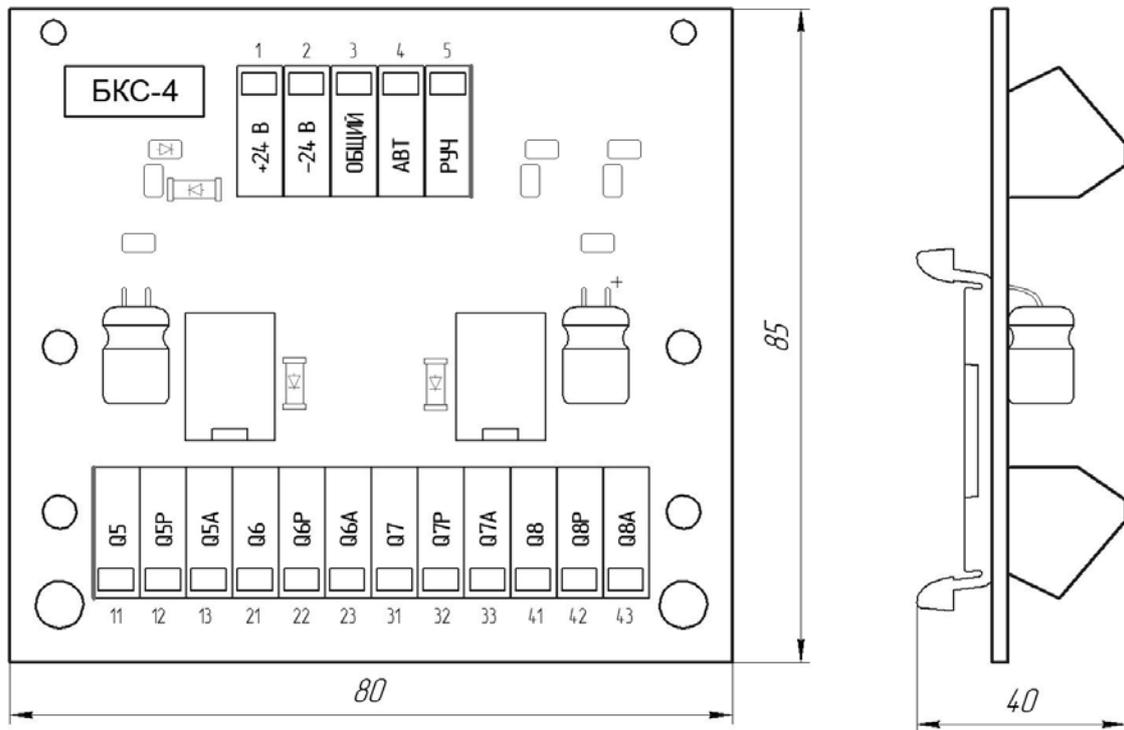
Рисунок Б.1 - Габаритные размеры блока коммутации сигналов БКС-4
