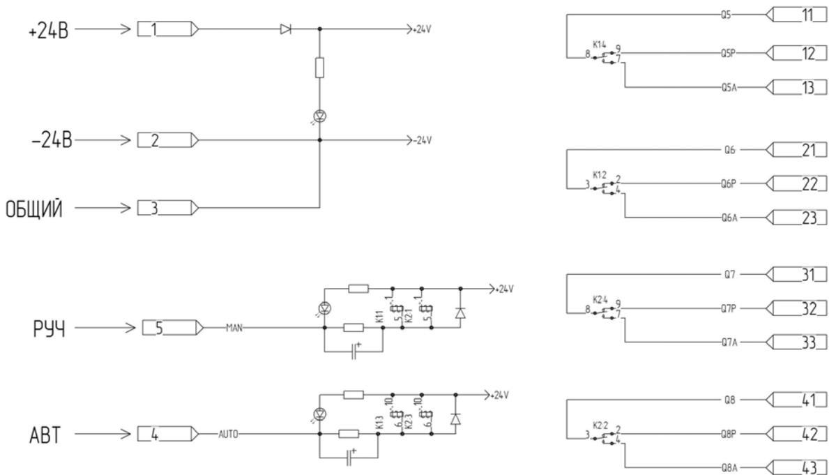
Рисунок. 2.1 – Электрическая схема блока коммутации сигналов БКС-4.
