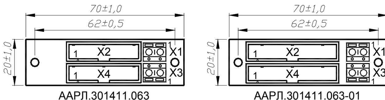
Рисунок 1 - Габаритные размеры ПЛР-2.
