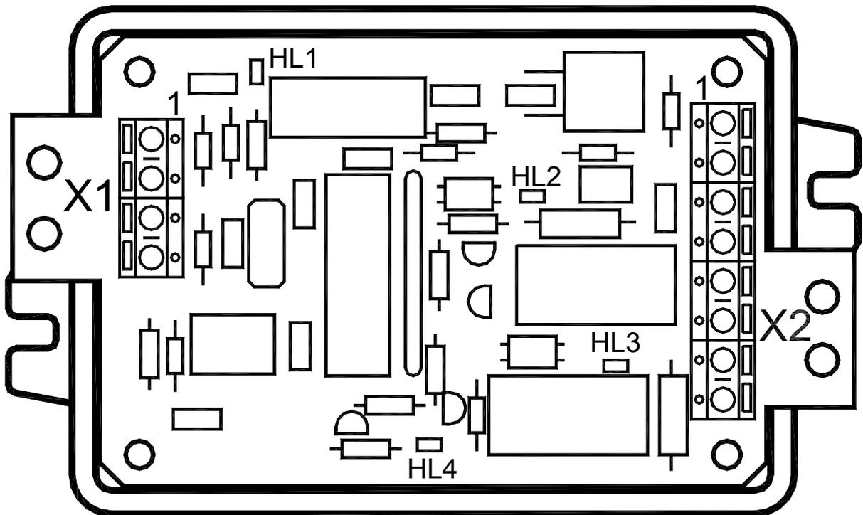
Рисунок 3 - Вид РЧВ со снятой крышкой.
